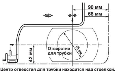
1. После определения положения отверстия для трубки на установочной пластине (→) просверлите отверстие для трубки (Ø65 мм) с небольшим наклоном в сторону наружного блока.
