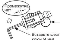
Не применяйте масло (охлаждающее машинное масло) при установке дренажного колпачка. Применение вызывает ухудшение состояния и утечку воды через пробку.
